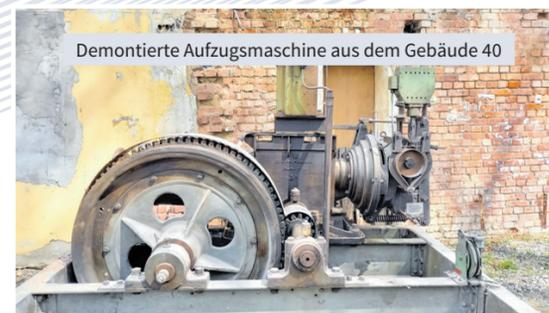
Demontierte Aufzugsmaschine aus dem Gebäude 40
